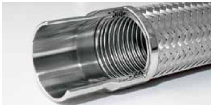
Производство металлорукавов полного цикла включает сварку труб из нержавеющей ленты, гидроформовку сильфонов и оплетение рукавов, 100% контроль качества на пневматических и гидравлических испытательных стендах. Металлорукава комплектуются любой концевой арматурой. Проектирование, разработка, производство и испытания продукции осуществляются по требованиям российских и международных стандартов и по техническому заданию заказчика.
